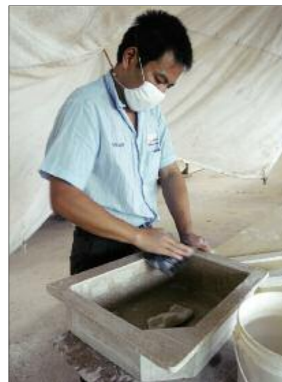
Un évier en phase de polissage. Selene laisse le choix du matériau à ses clients. Toutes sortes de granit ou marbre leur sont proposées, mais ils optent le plus souvent pour le Corian, sans joints, pour un rendu comparable à la pierre.
