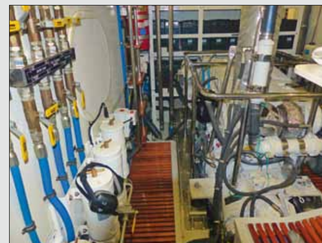
La salle des machines du Selene 66 avec, en son centre, le bloc Cummins. Un day tank de 600 l sert à assainir le carburant.
