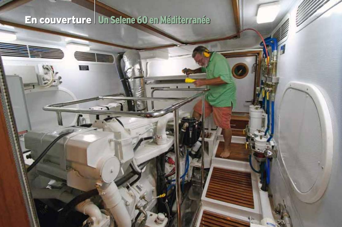
Au cours des navigations prolongées, Jean-Yves inspecte la cale moteur toutes les deux heures en vérifiant la température à l'aide d'une sonde portable à rayon laser.
