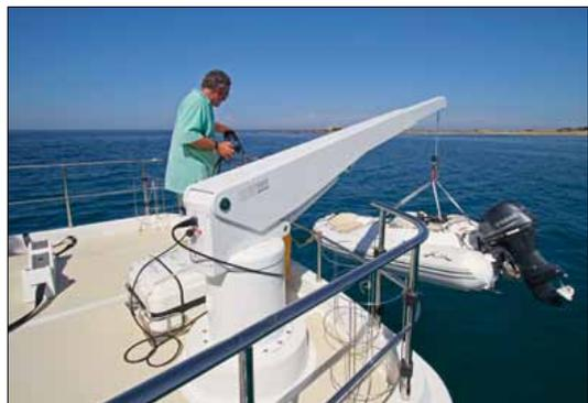
La mise à l'eau de l'annexe est une manœuvre qui réclame de la dextérité malgré l'efficacité d'une grue Steelhead Marine, conçue pour soulever jusqu'à 750 kg.
