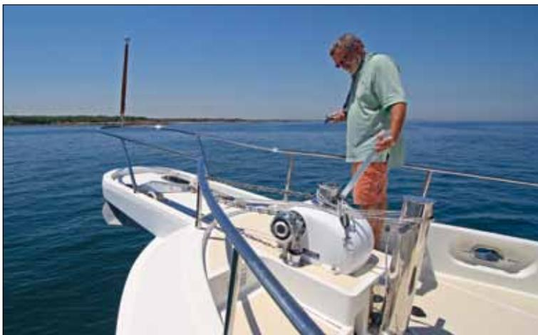
Toutes les manœuvres sont assistées par une télécommande Yacht Controller, qui permet de diriger le bateau à distance. La baille à mouillage abrite deux lignes de 100 et 70 mètres de long en cablot de 13', reliées à deux ancres de 40 et 63 kg ! «Ceinture et bretelles !»
